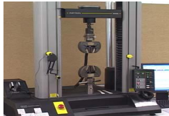
Fig 2.2: Tensile test Rig
