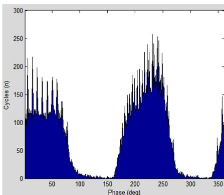
Fig.5(a).Phase plot ( $\varphi$ -n) of void discharge
