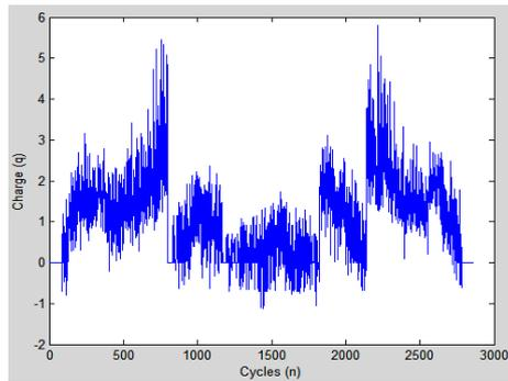
Fig.7 (d) Skewness plot (n-q) of void discharge
