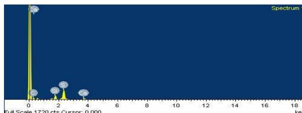
**Fig4.17 EDS : PPS/40%GF/7% nano-CaCO<sub>3</sub>**
