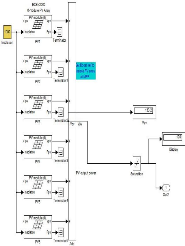
Fig.16: PV array module
